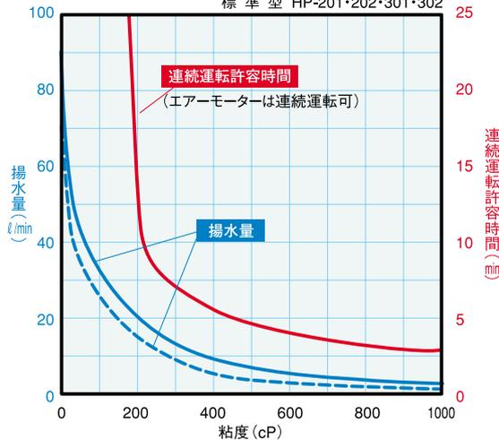
※粘度が高くなると吐出量、揚程、連続運転許容時間は減少します。上表を参考にしてください。（粘度は液温により変化しますので、実際に使用される液温での粘度でご検討下さい。）
