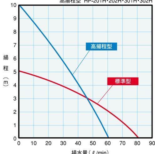
※エアードライブモータータイプの場合は、使用空気圧0.6MPaの時です。
